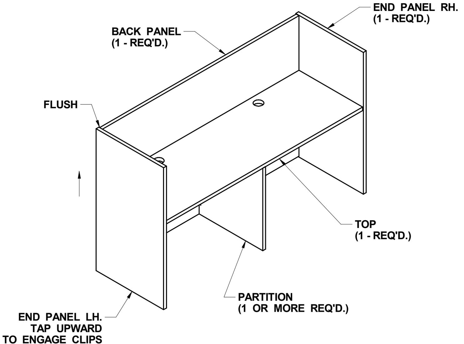
1. ENGAGE SHOULDER SCREWS INTO BACK AND TAP UPWARD TO FLUSH ENDS WITH BACK.
